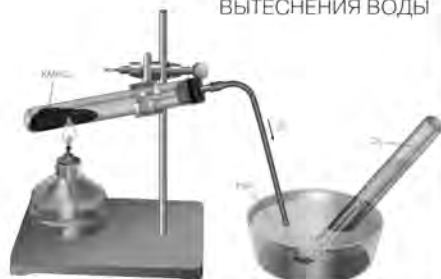
ПОЛУЧЕНИЕ КИСЛОРОДА И СОБИРАНИЕ ЕГО МЕТОДОМ ВЫТЭСНЕНИЯ ВОДЫ
